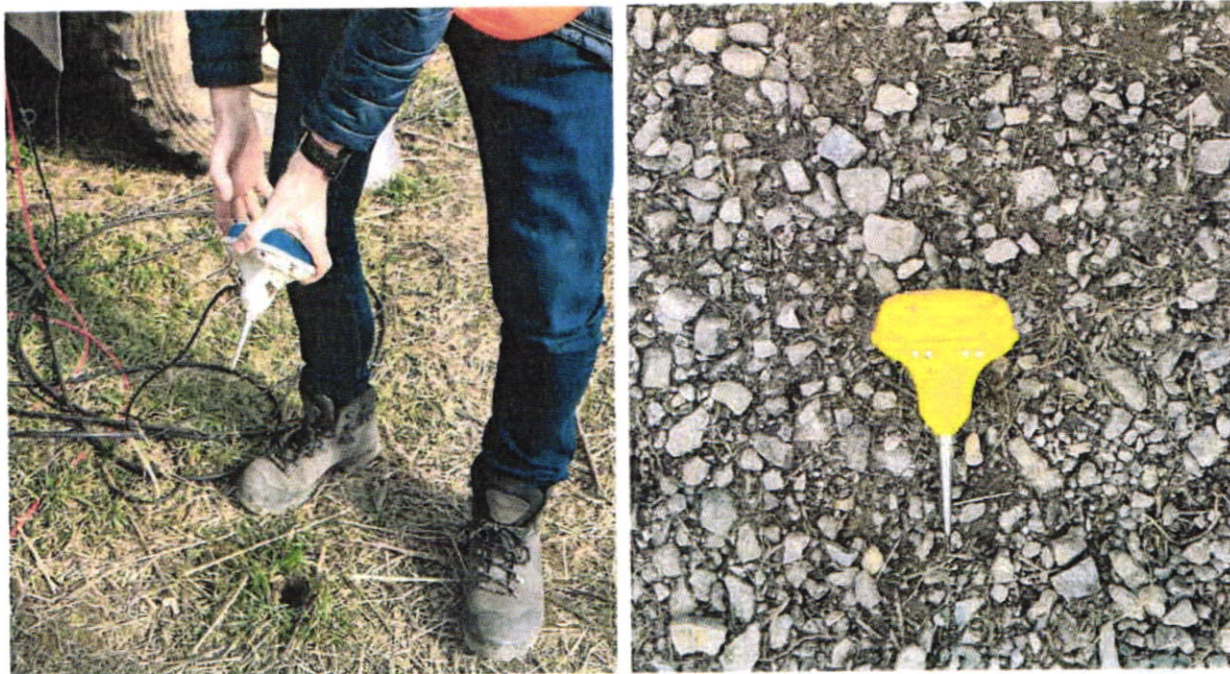
Slika 5. Prikaz geofona (prijamnika)
